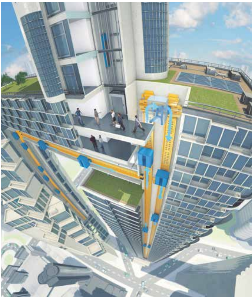
MULTI von thyssenkrupp ist der erste seillose Aufzug der Welt. Linearmotortechnologie ermöglicht es, mehrere Kabinen im selben Aufzugschacht vertikal und horizontal zu betreiben. Im Vergleich zu Standardaufzügen steht MULTI für kürzere Wartezeiten, höhere Kapazität, geringeren Platzbedarf und weniger Gewicht und soll damit die Konstruktion von Gebäuden revolutionieren.
